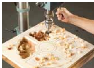
Passate l'interno del vassoio con una punta Forstner da 50,8mm in un trapano a colonna. Quite el material utilizando una broca Forstner de 50,8mm en una taladradora de columna.
