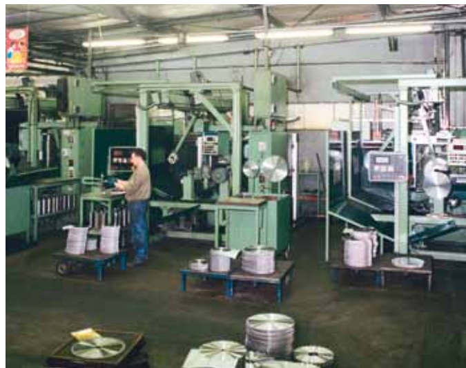
Rettifica e tensionatura automatizzata. Rectificado y tensado automatizado.
