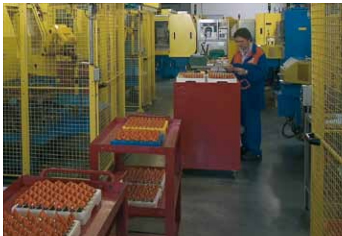
Affilatura multiasse a CNC robotizzata. Cargando el control numérico multi-axial automático
