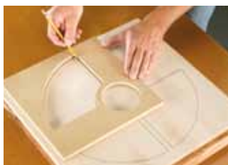
Tracciate la forma all'interno della dima. Dibuje la forma en el molde
