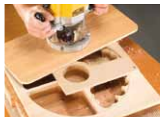
Rifinite l'interno utilizzando la fresa per vassoi inserita in una mandrino. Termine el trabajo utilizando la fresa para bandejas insertada en el mandril.
