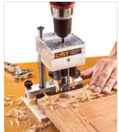
Utilizzo con trapano manuale. A utilizar en taladro manuales
