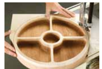
Rifinite la parte esterna del vassoio utilizzando una sega a nastro. Trabaje la parte exterior de la bandeja utilizando una sierra de cinta.
