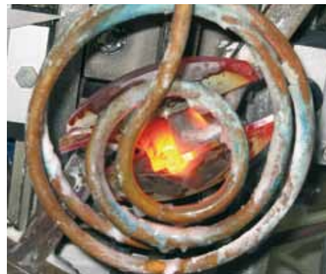
680° en pocos segundos y la solda esta terminada.
