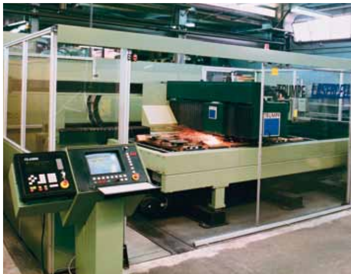
Tagli laser del corpo lama. Corte al láser del cuerpo de las sierras.
